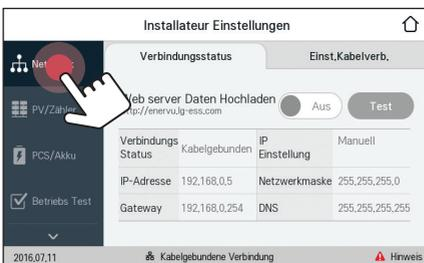
Unter [Installateur Einstellungen] auf [NETZWERK] tippen. Es wird der derzeitige Status der Netzwerkverbindung angezeigt. Wenn Sie die Verbindung zum EnerVu-Server herstellen wollen, drücken Sie auf [Web-Server Daten hochladen], um auf [Ein] zu wechseln. Um die Funktion wieder auszuschalten, erneut auf [Web-Server Daten hochladen] drücken.
