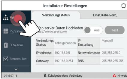
Unter [Installateur-Einstellungen] auf [NETZWERK] tippen. Es wird der derzeitige Status der Netzwerkverbindung angezeigt.
